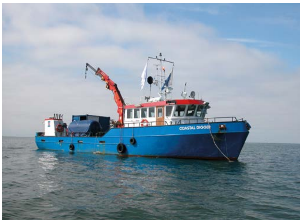
Afb. 4.2 Het werkschip de Coastal Digger op locatie met aan boord een kraan, een duikcontainer en een decompressietank.
