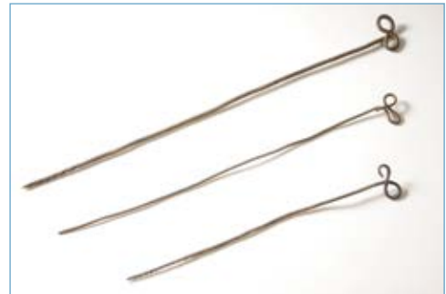
Afb. 7.20 Kardoesprikkers werden gebruikt om door het zundgat heen de kardoes (een bundel papier of stof gevuld met kruid) in de loop van een kanon aan te prikken.
