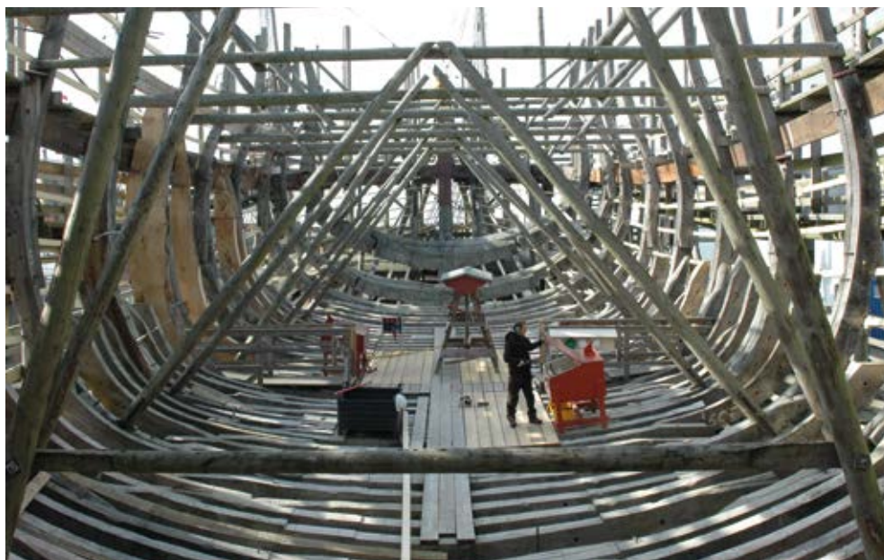
Afb. 2.9 Het spantenraam van een schip is zo zwaar uitgevoerd dat je daar meestal wel delen van terugvindt.
