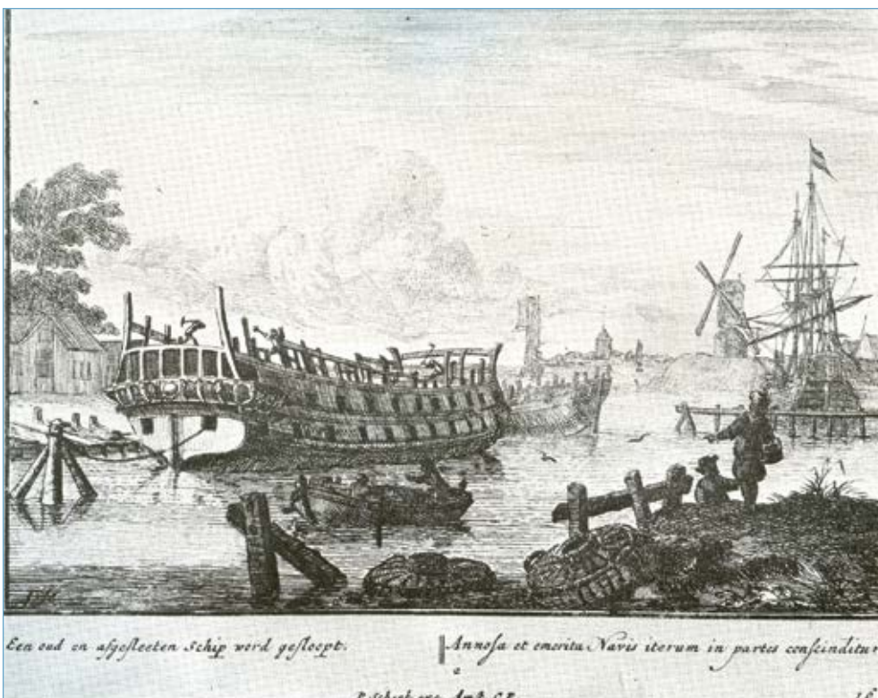
Afb. 4.13 Prent van Siewert van der Meulen, omstreeks 1700, 'Een oud en afgesleeten schip wordt gesloopt'. Schepen die niet vergingen, waren na ongeveer 15 tot 25 jaar versleten en werden dan gesloopt.
