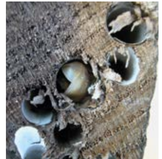
Afb. 3.8 Detail van de paalworm in het hout. We zien de met kalk afgezette gangwanden en een schelpje van de paalworm, waarmee hij zich een weg raspt door het hout.
