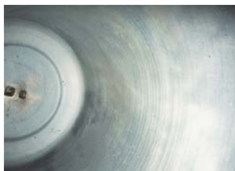
Afb. 11.24 Aan de binnenkant van de klok is duidelijk te zien hoe hij is afgedraaid om hem te stemmen.
