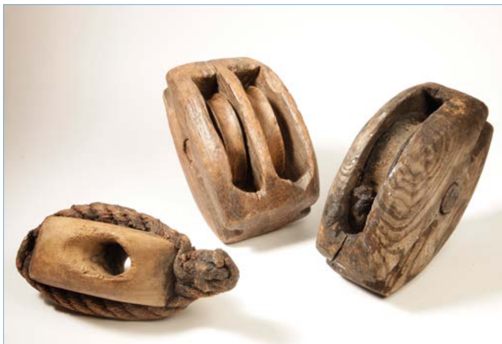
Afb. 12.10 Drie voorbeelden van blokken: enkelschijfs- en dubbelschijfsblok en een blok om touw te geleiden.
