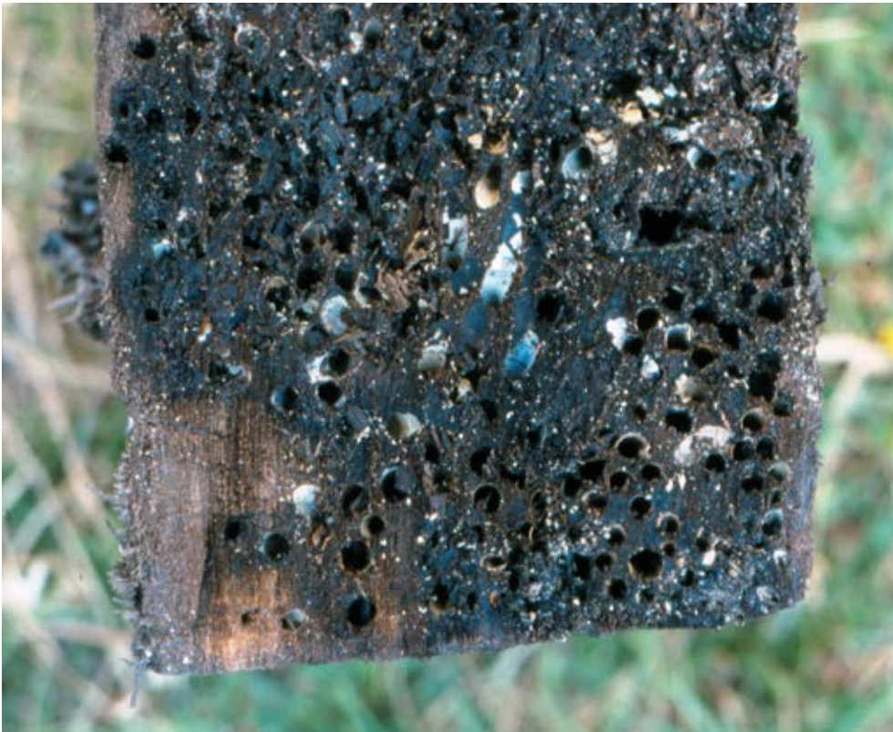
Afb. 3.7 Zelfs als een inhoud er aan de buitenkant nog gaaf uitziet, kan hij van binnen al volledig door de paalworm zijn aangetast.
