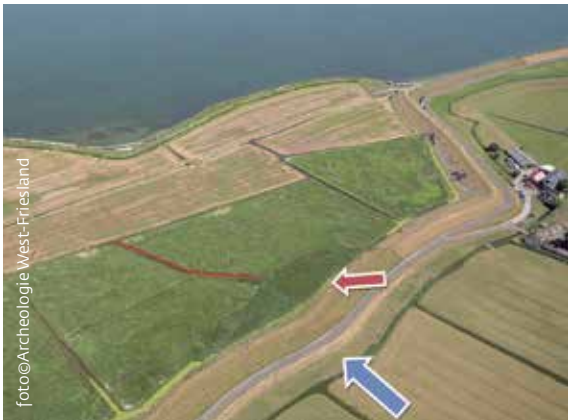
Vindplaats 5.3: de kronkel in de dijk (blauwe pijl) verraaft de aanwezigheid van een reparatie, waarbij de dijk na doorbraak iets landinwaarts opnieuw is opgebouwd. Net voor de dijk (rode pijl) is de begroeide depressie ter hoogte van het oude kolk gat zichtbaar. Een sloot (rode stippellijn) watert de depressie af.
