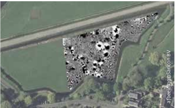
Magnetometriebeelden: er zijn duidelijke contrastverschillen te zien (ferro-houdende objecten) op de plaats waar de kloosterkapel heeft gestaan.
