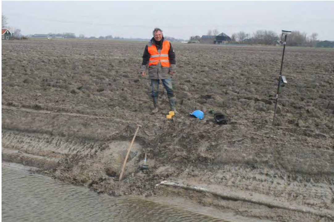
Bijlage B12: OSL-monsterbuis op de slootprofiel locatie N241- Loc 3B2 (Tabel 1). De bemonsterde zandige laag (tussenlaag) bij de schep ligt ingeklemd tussen twee donkere oxidatie niveaus (restanten van veen).
