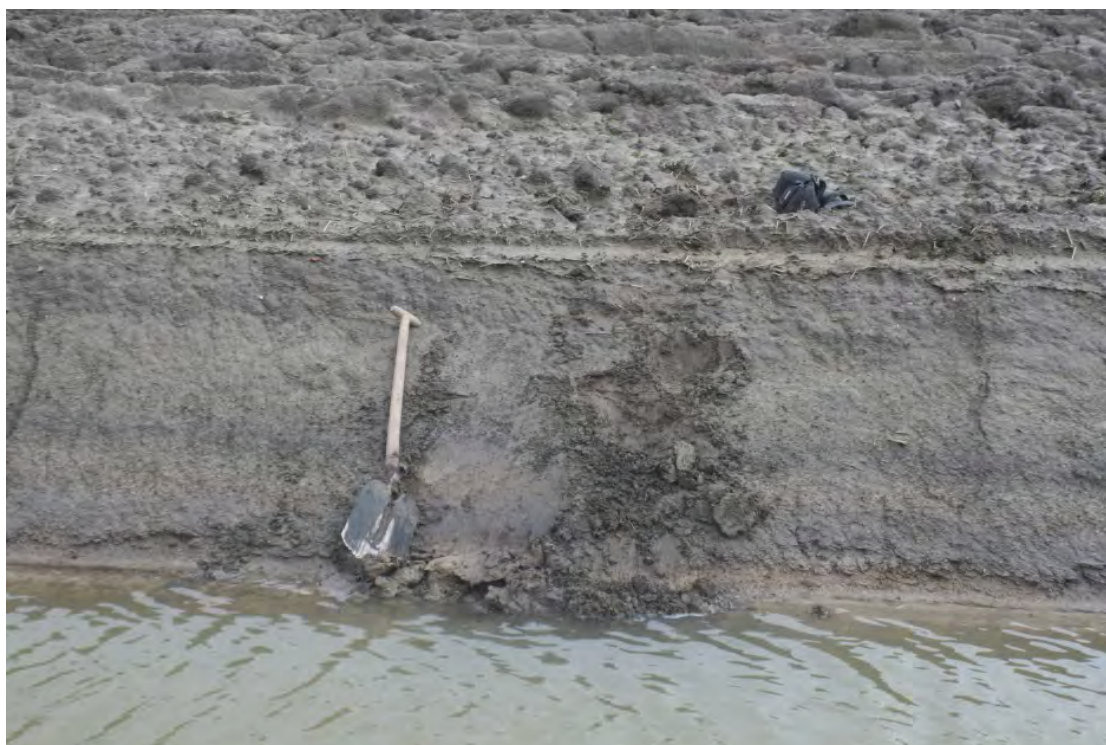
Bijlage B16: Meest noordelijke opname van de opnamelocatie 3 (N241-Loc 3C). De twee oxidatieniveaus tussen de grijze kleilaag zijn ook hier aanwezig maar alleen wat minder duidelijk ontwikkeld. Ook is de tussenliggende klei iets humeuzer (lichtbruin grijs).
