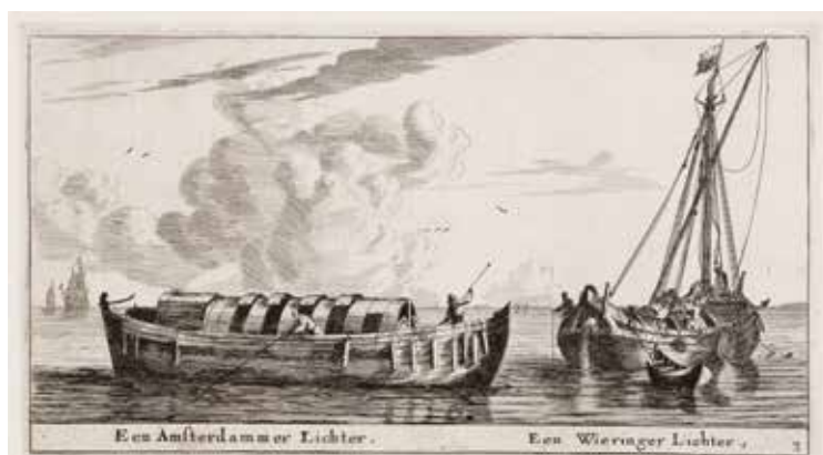
Lichterschepen, brede vrij ondiepe schepen die voor de overslag van goederen en het bevoorraden van de schepen zorgde, zoals te zien is op deze prent
